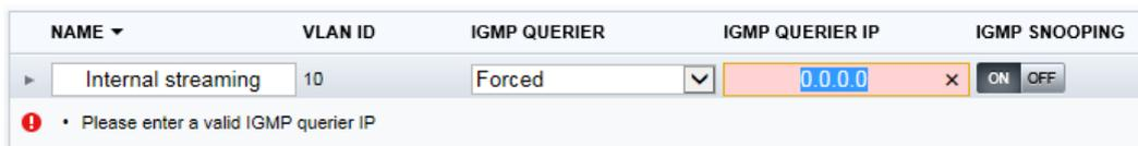
В режиме Forced (Принудительно) и Auto (Авто) для IGMP требуется действительный исходный IP-адрес запросчика IGMP для правильного согласования функций. Обратите внимание, что введенный IP-адрес запросчика IGMP используется только как исходный адрес запросчика, и сетевой интерфейс не создается.
