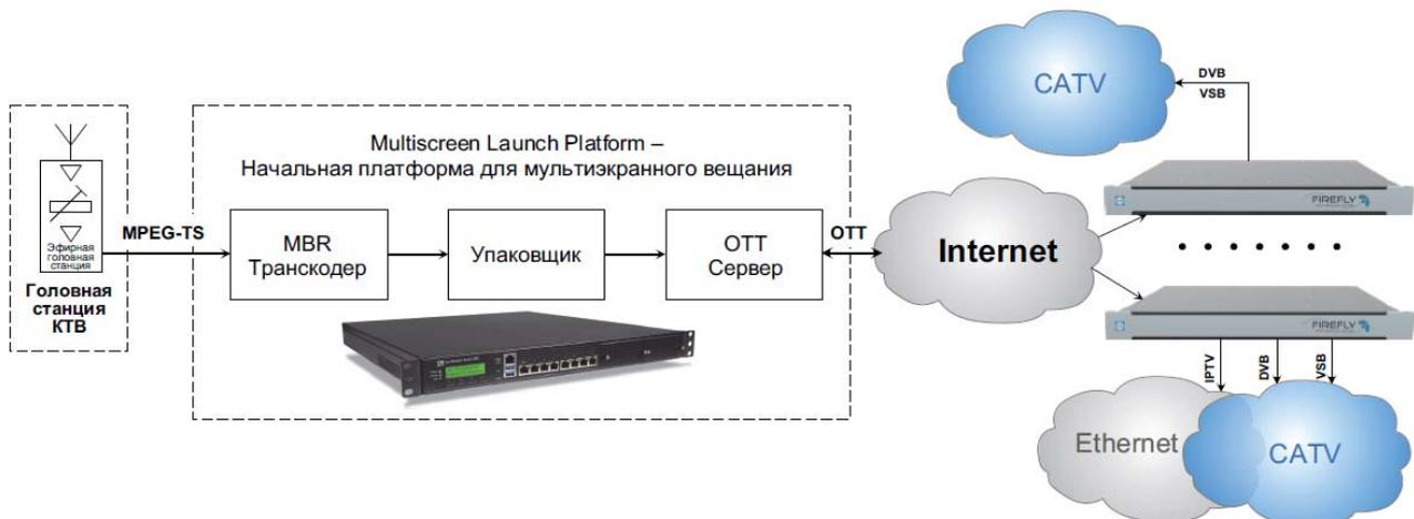
Управление OTT станцией осуществляется через встроенный WEB интерфейс. Настройка и конфигурирование осуществляется с использованием встроенной мощной специализированной системы VidiOS™ с возможностями анализа, логгирования, записи и отображения видеопотоков. Платформу можно дополнить, установив блок группового видеоконтроля **AllSeeing Eye INCA 5420**.
