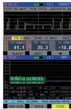
Затем был проведен анализ спектра сигнала. На рисунке изображен только участок спектра. Здесь центральная частота, на которой расположена несущая одного из цифровых мультиплексов, равна 770 МГц. В нижней части экрана отображаются те же параметры, что и при измерении спектра эфирного сигнала.
