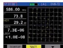
Следующим пунктом измерений стало построение конstellационной диаграммы сигнала цифрового эфирного ТВ. На рисунке мы видим характерный для стандарта DVB-T2 поворот конstellационного созвездия, за счет которого повышается соотношение сигнал/шум и устойчивость приема сигнала в реальных условиях. В левой части картинки мы видим упомянутые ранее параметры частоты сигнала, его уровня, MER, CBER и LBER. После нажатия кнопки «ПОВТОР» прибор начнет построение созвездия заново.
