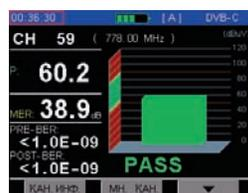
Для примера был взят 59-й канал частотой 778,0 МГц, на котором располагается один цифровой мультиплекс. На рисунке приведен снимок экрана прибора в момент измерения. Здесь, как и в предыдущих примерах, можно увидеть мощность сигнала (60,2 дБмкВ), коэффициент ошибок модуляции MER (38,9 дБ), а также значения коэффициентов битовых ошибок до декодера Рида-Соломона (PRE-BER) и
