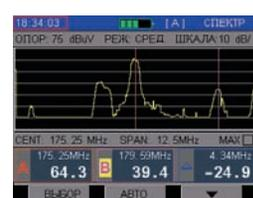
Далее прибор был испытан в режиме анализатора спектра. Как можно видеть на диаграмме, красный маркер установлен на частоту 175,25 МГц — несущую изображения 6-го эфирного канала.
