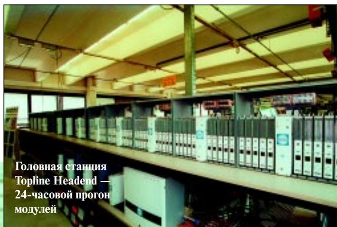
**Головная станция Topline Headend — 24-часовой прогон модулей**
